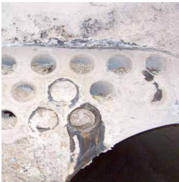
Foto del interior de una caldera donde no se han realizado las operaciones pertinentes de limpieza y purgas.
