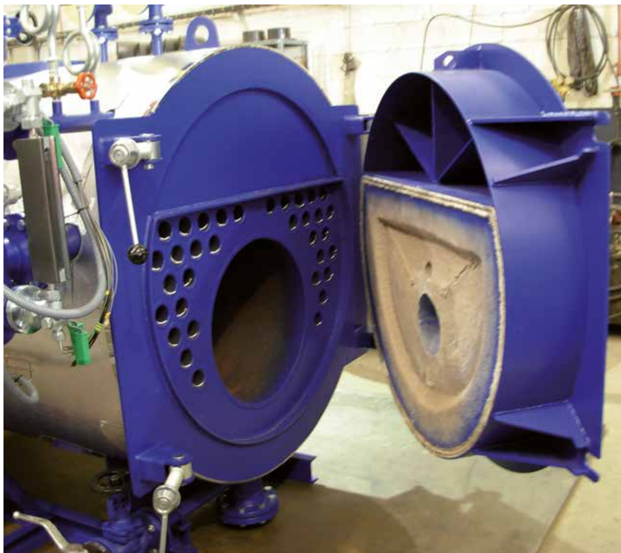
Interior de una caldera HDR
