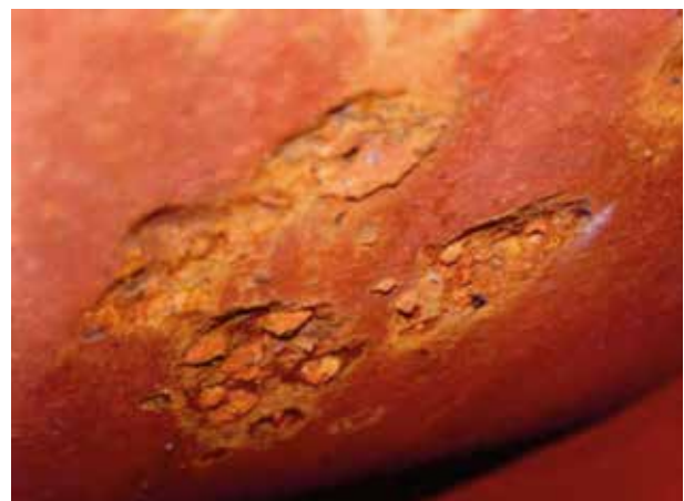
Foto de corrosión cáustica.
