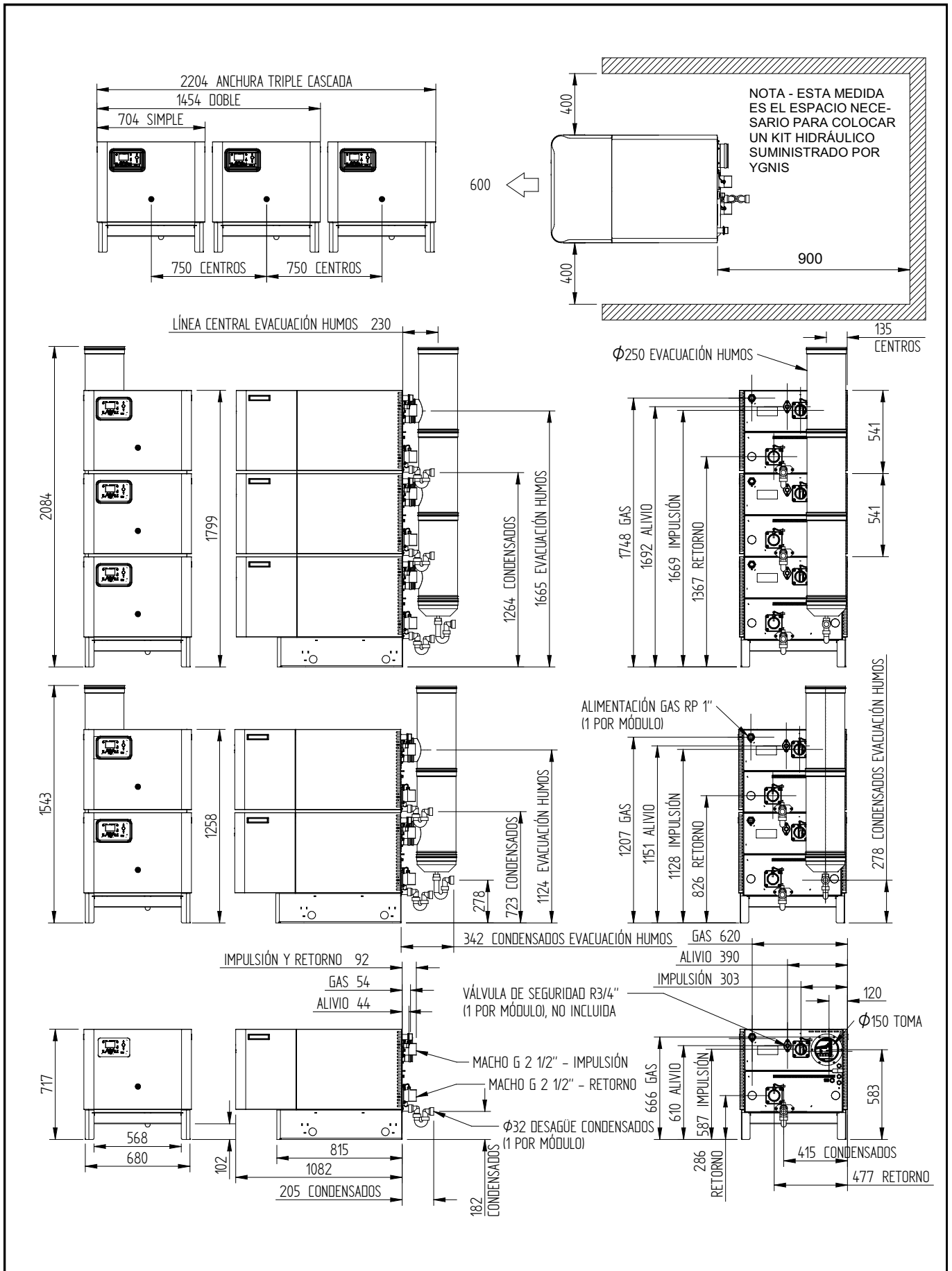
Figura 3.1.2 - Dimensiones y espacio libre para los modelos 150/200/250
