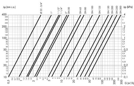
La velocidad máxima recomendada del fluido en las conexiones del dispositivo es ~ 1,2 m/s.La tabla siguiente indica los caudales máximos para respetar esta condición.
